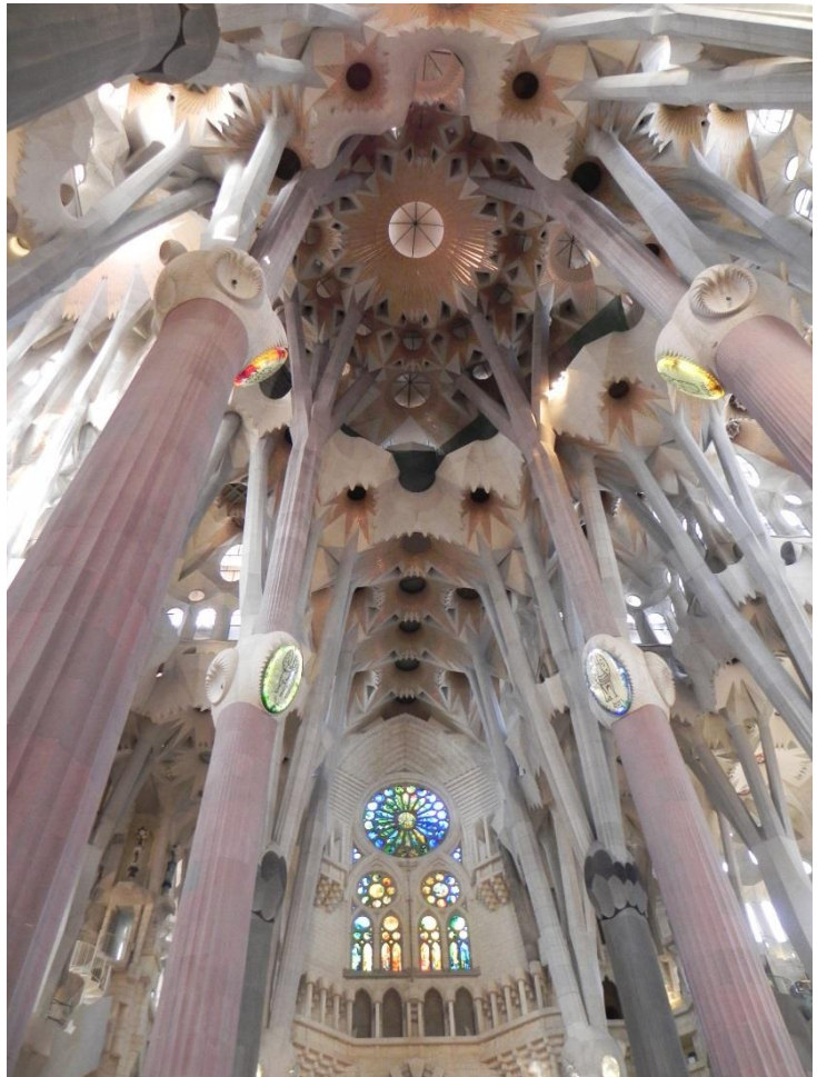
Hvælvingen i La Sagrada Família. Det skulle være en hyperbolsk paraboloid.
